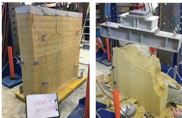
Slika 15. Prikaz nastanka razpok zaradi vertikalne obremenitve za Steno 1 (levo) in končna porušna oblika za Steno 2 (desno).
