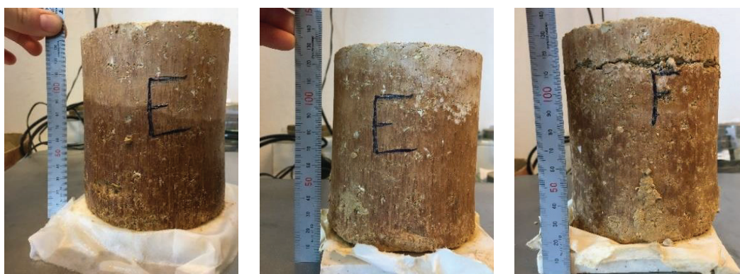
Slika 8. Zračno suh preizkušanec po 8 urah stika z vodo preko vlažne polsti (levo) in isti preizkušanec po 11 dneh stika z vodo preko vlažne polsti in 17 dneh sušenja na zraku (sredina). Na desni sliki je paralelni preizkušanec, ki je bil 11 dni v stiku z vodo preko vlažne polsti in 17 dni sušen na zraku z vidno večjo razpoko.
