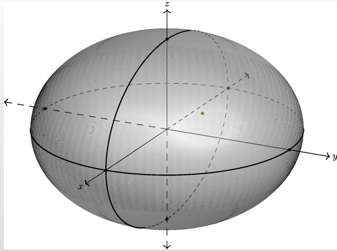
Določimo elipsoidni koordinatni sistem: ekvator (geodetska širina) in začetni meridian (geodetska dolžina).
