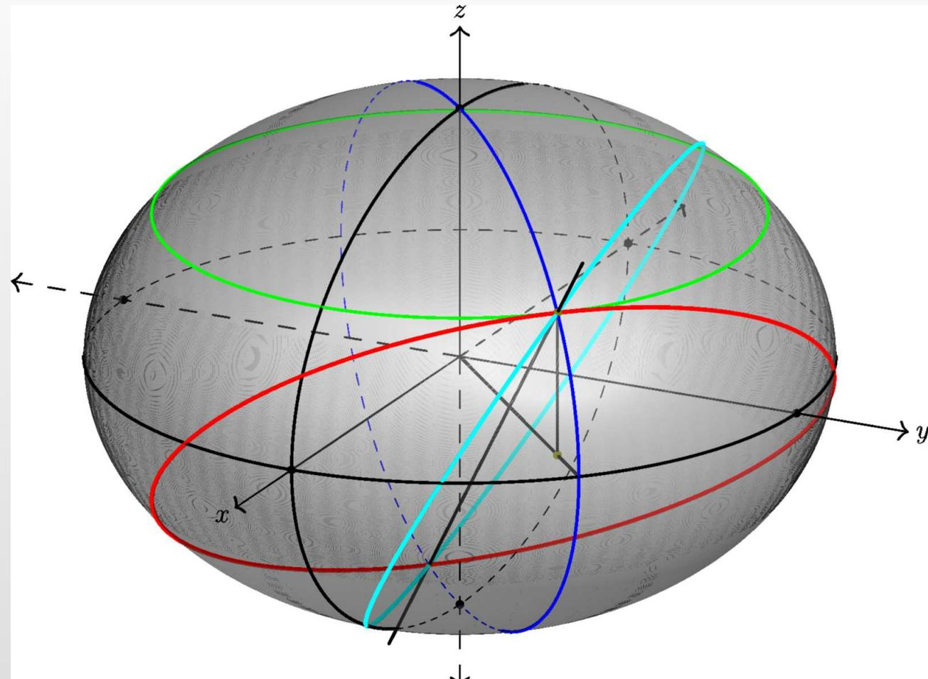
Meridian 1. vertikal Vzporednik Presek pod poljubnim azimutom
