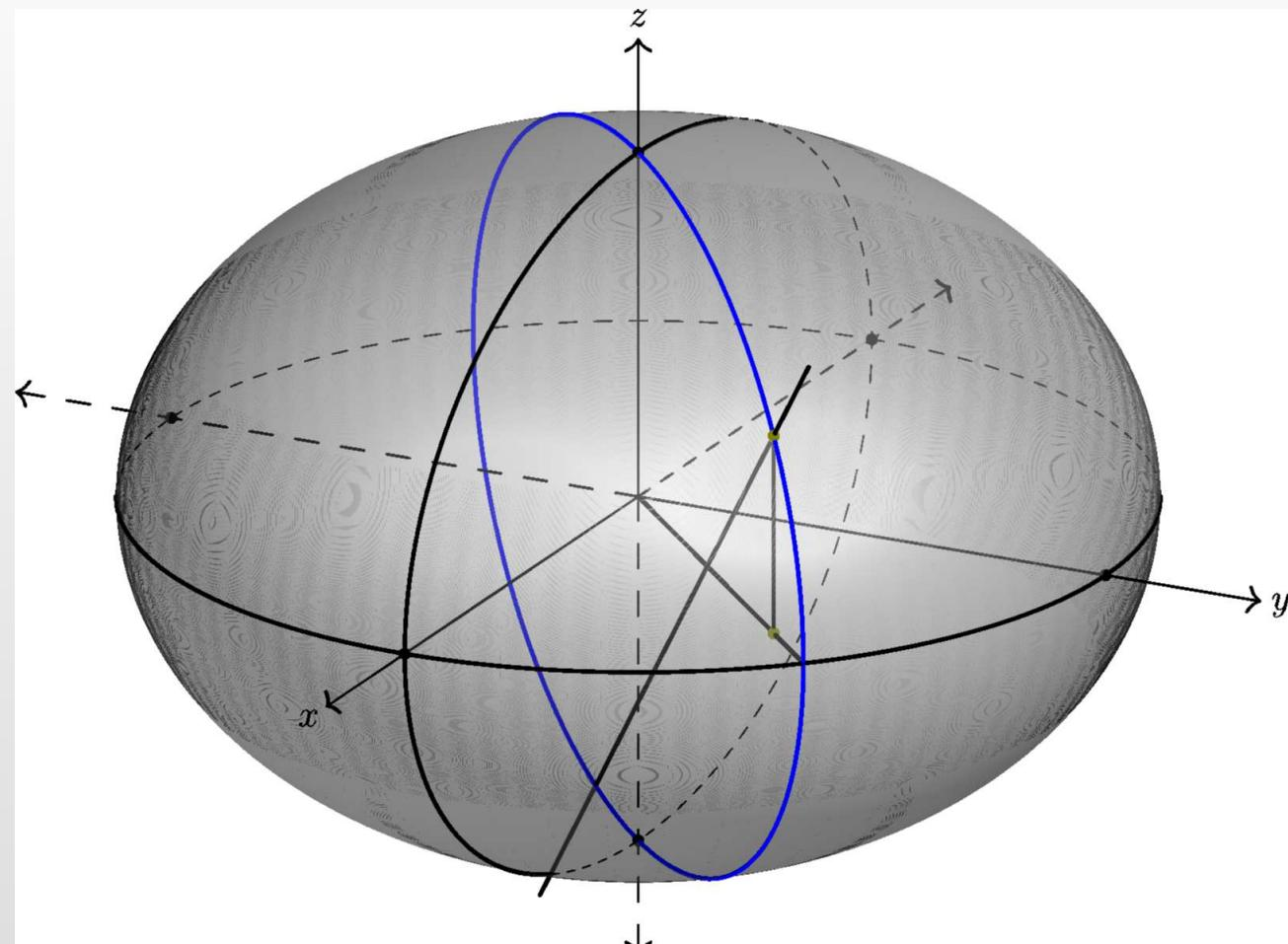
Elipsoid sekamo s sekantno ravnino, ki gre skozi rotacijsko os (os  $z$ ) in normalo na točko - dobimo lokalni meridian točke (elipso).
