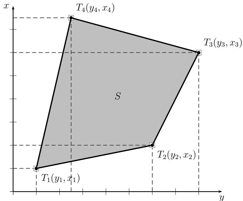
Slika 1: Določitev površine iz koordinat točk poligona
