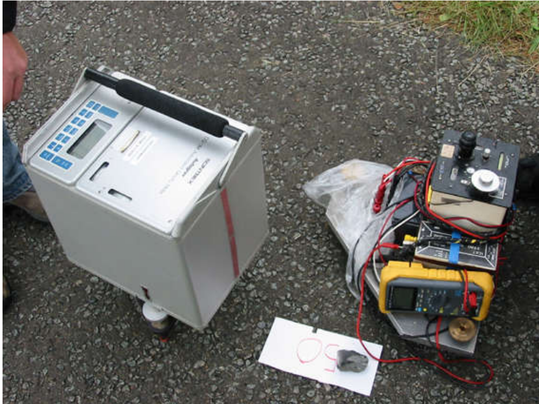
Slika 6.4: relativna gravimetra: Scintrex (levo), LaCoste Romberg (desno)
