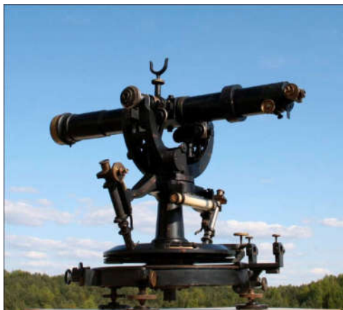
teodolita iz časa meritev meridianskega loka pod vodstvom Struvea, 1816 - 1855
