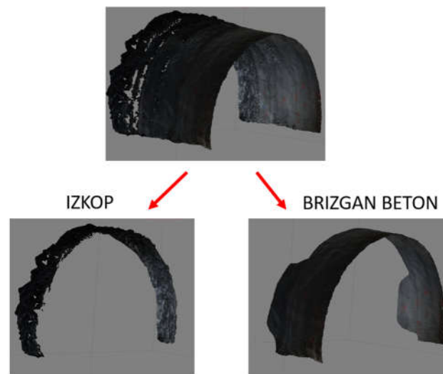
Slika 6: Segmentacija oblaka točk na območje, ki pripada izkopni površini in površini brizganega betona.
