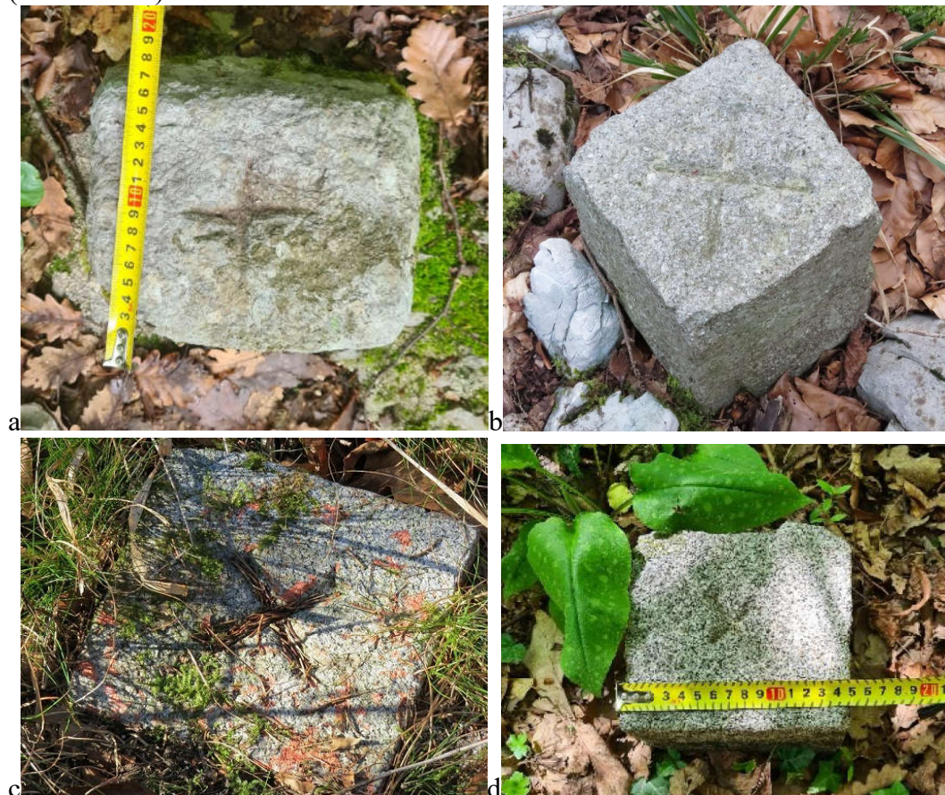
Slika 1: Tipični primeri geodetskih znamenj: a) Hrib pri Malem Lipovcu, trig. točka 357. IV. red, trig. okraj 15, najverjetneje še avtro-ogrska stabilizacija (foto: R. Maver, 2021), b) Smrečni rob, 463. IV. red, trig. okraj 16, stabilizacija GIJNA iz obdobja po II. svetovni vojni (foto: M. Triglav Čekada, 2021), c) Čelo, 48. IV. red, trig. okraj 16, stabilizacija GZS iz obdobja po II. svetovni vojni (foto: M. Triglav Čekada, 2021), d) Jarčev hrib 356. IV. red, trig. okraj 15, iz novejšega obdobja (foto: R. Maver, 2021).
