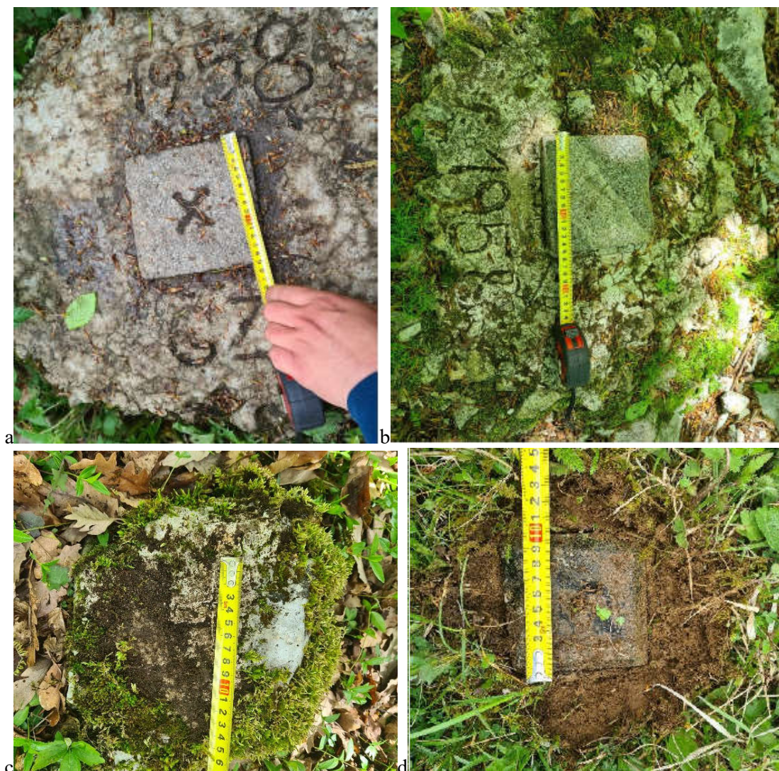
Slika 5: Nekaj zanimivih primerov geodetskih znamenj iz območja Žužemberka: a) Lisec, 50. III. red, trig. okraj 15, b) Ostri vrh, 56. III., trig. okraj 15, c) Sveta Katarina, 384, II. red – klesan kamen s pravokotnim križem (20 cm × 25 cm) in d) Kamniti dol, 207. VIII., trig. okraj 15 – betonsko znamenje z luknjico na vrhu (10 cm × 10 cm) (foto: R. Maver, 2021).
