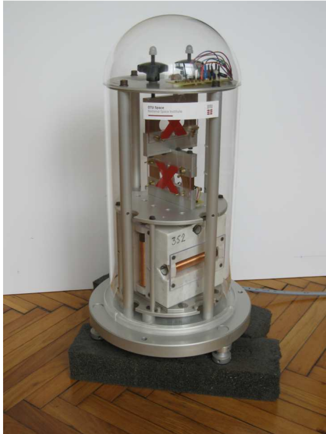
Slika 2: Triosni fluxgate magnetometer za observatorij
