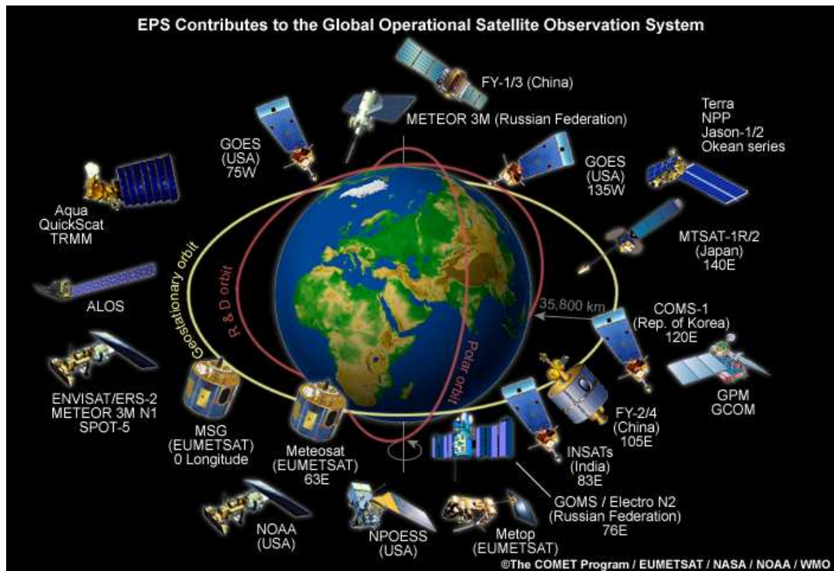
Slika 1: Sedanji sistem satelitov, namenjenih opazovanju Zemlje. Podrobneje so predstavljeni samo meteorološki sateliti in tisti, ki so neposredno uporabni za meteorologijo. Tisti sateliti, ki krožijo nad ekvatorjem od zahoda proti vzhodu s točno tako hitrostjo, kot se pod njimi vrti Zemlja (na višini malo manj kot 35 tisoč km), so tako vedno nad istim predelom – zato jim rečemo geostacionarni sateliti. Sateliti na nižjih krožnicah (okrog 800 km visoko) krožijo okrog Zemlje hitreje (eno obkroženje Zemlje v kaki uri in pol), tako da ponavadi obkrožijo Zemljo večkrat dnevno z orbitami približno preko obeh polov – zato jim rečemo polarno-orbitalni sateliti. Vir: EUMETSAT, Copyright 2011 © EUMETSAT, iz http://www.eumetsat.int/eps_webcast/eps/print.htm#s1p1 povzeto 3. 1. 2011.
