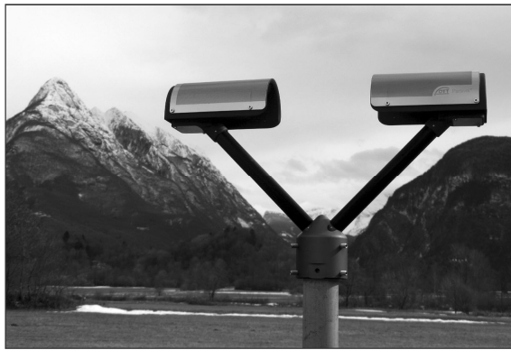
Slika 1: Optični disdrometer OTT na meteorološki postaji Bovec Letališče (Fotografija: Sašo Petan)
