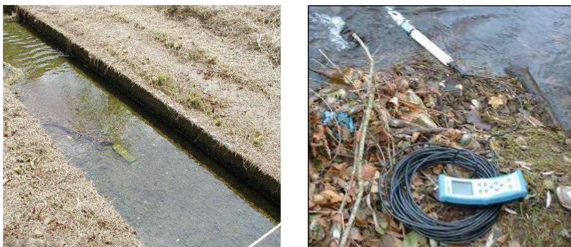
Slika 3 – Merilec višine vode Starflow (levo) in multiparametrska sonda Hydrolab (desno)
