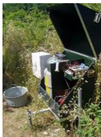
Slika 5 - Inštrument ISCO (jemnaje vzorcev vode za določanje lebdječih delcev v vodi)
