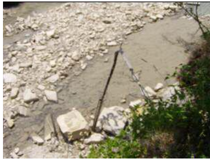
Slika 6 - Tlačna sonda v strugi reke Dragonje (merjenje gladine vode)
