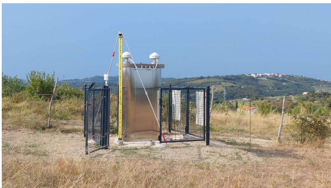
Slika 6: Nivelmanske meritve na točki geodetske mreže 0. reda Livade (foto: GURS)
