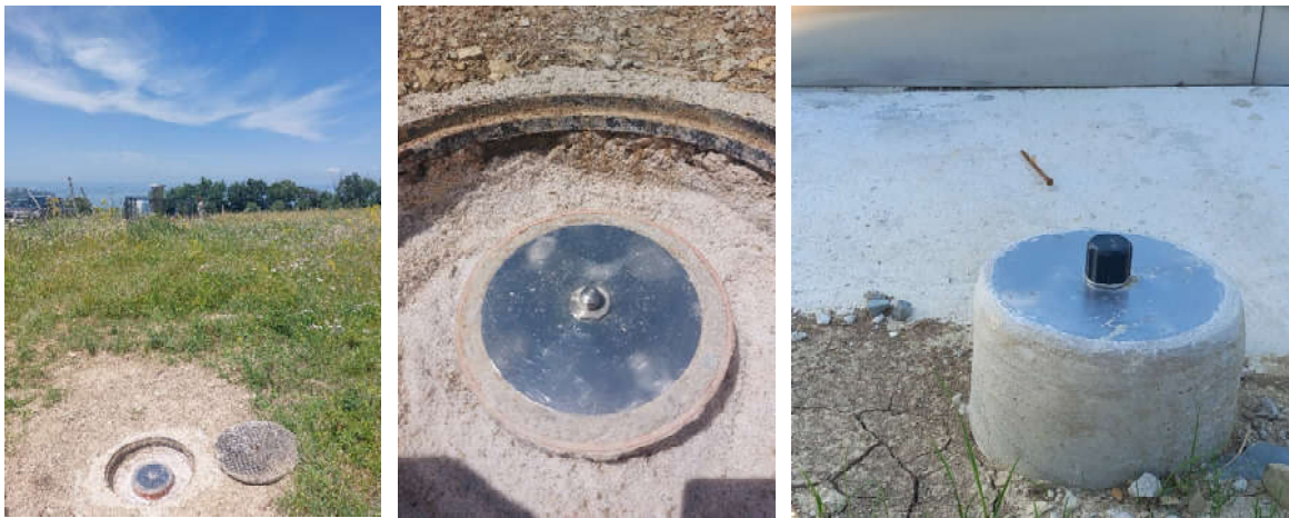
Slika 8: Točke mikromreže, ki so postavljene v okolici glavnega stebra (foto: GURS)
