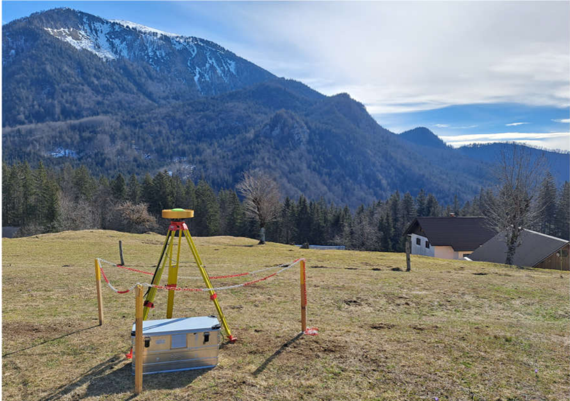
Slika 3: Izvedba 24-urnih meritev GNSS na Javorniškem Rovtu (foto: N. Fabiani)
