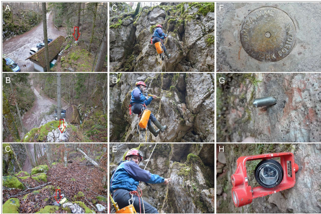
Slika 2 – Stabilizirane stojiščne točke nad parkiriščem pred vhomom v Križno jamo, iz katerih je bil opravljen del meritev, in sicer (A) stabilizirana točka 100, (B) 101 in (C) 102. Slike Č-E prikazujejo postopek fiksacij točk na (1L-4L) in v neposredni okolici (1S-4S) potencialno nestabilne skalne gmote. Slika F prikazuje detajl načina stabilizacije stojiščnih točk 57 in 58, slika G detajl načina fiksiranja točk 1L-4L, 1S-4S, 100, 101 in 102, slika H pa točko 1S v času meritev z mini prizmo.
