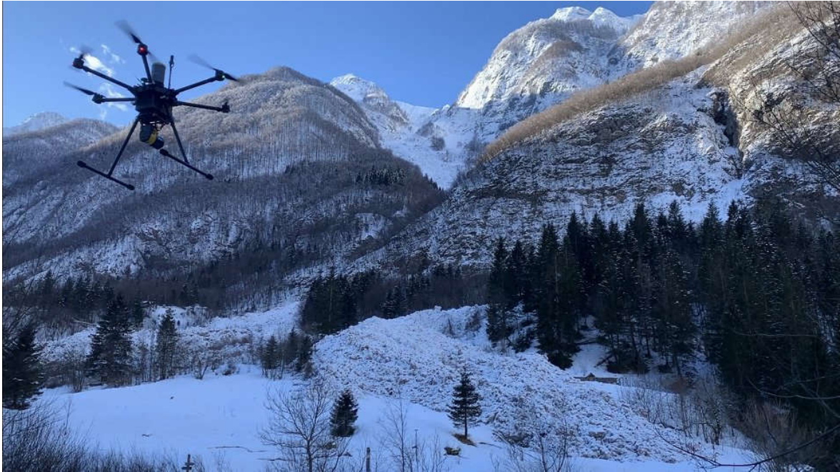
Slika 3: Skeniranje snežnega plazu Skok v Lepeni (26. 1. 2021) z laserskim skenerjem YellowScan Surveyor Ultra, integriranim na daljinsko vodeni letalnik DJI M600 Pro.
