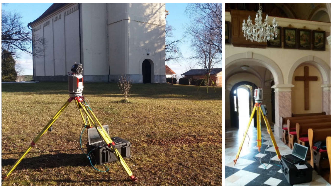
Slika 8: Terestrični laserski skener VZ-400 (vir: Gorazd Prašnikar).
