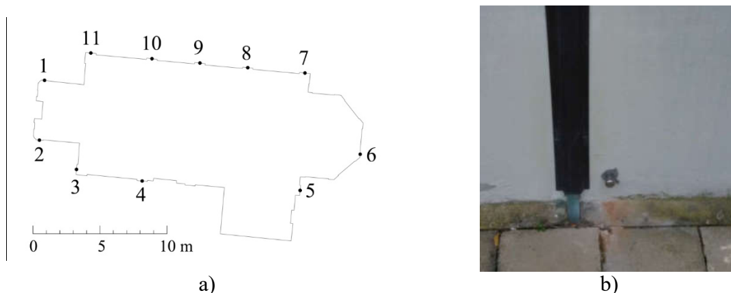
Slika 5: a) Vgrajeni reperji v cerkvi. b) Reper 5.
