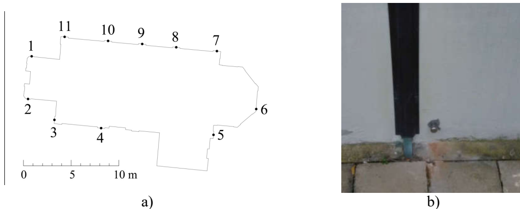
Slika 4: a) Vgrajeni reperji v cerkvi. b) Reper 5.
