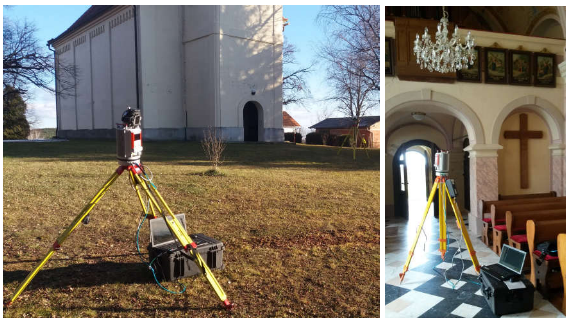
Slika 7: Terestrični laserski skener VZ-400 (vir: Gorazd Prašnikar).
