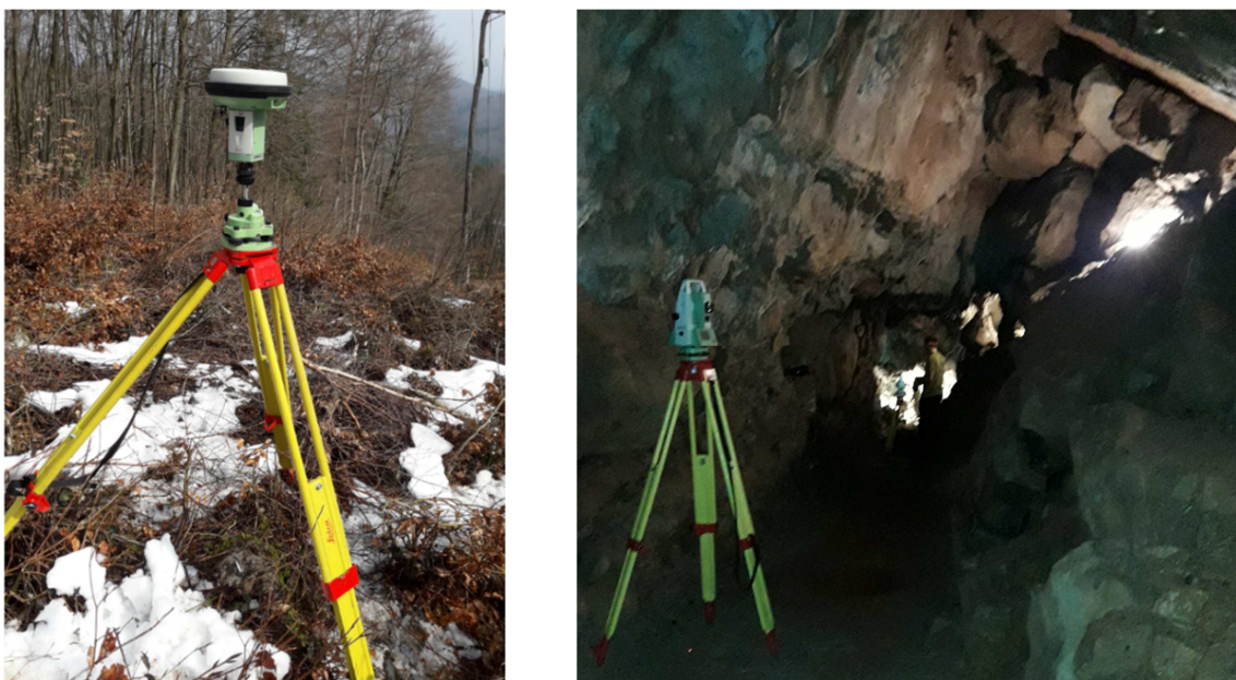
Slika 2 – Instrument GNSS (levo) in klasična terestrična izmera s tahimetrom (desno).
