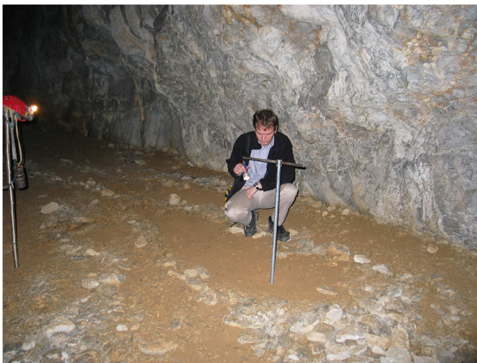
Slika 5 - Na nagnjenih tleh rova so poligoni zaradi polzenja tal razpotegnjeni
