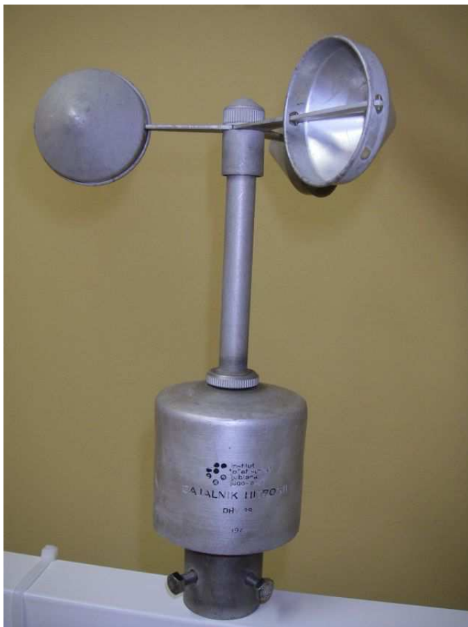
Slika 1 - Klasični optoelektronski senzor za hitrost vetra, izdelan na Institutu Jožef Stefan (IJS) sredi 80. let preteklega stoletja
