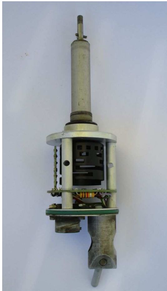
Slika 4 - Klasični optoelektronski senzor za smer vetra razvit na Institutu Jožef Stefan (IJS)
