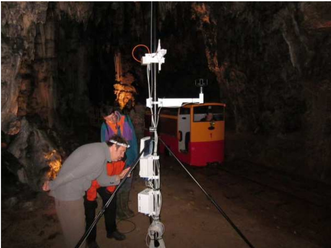
Slika 9 - Avtomatske meritve "vetra" z 2D UZ anemometrom ob železniški progi v Postojnski jami.
