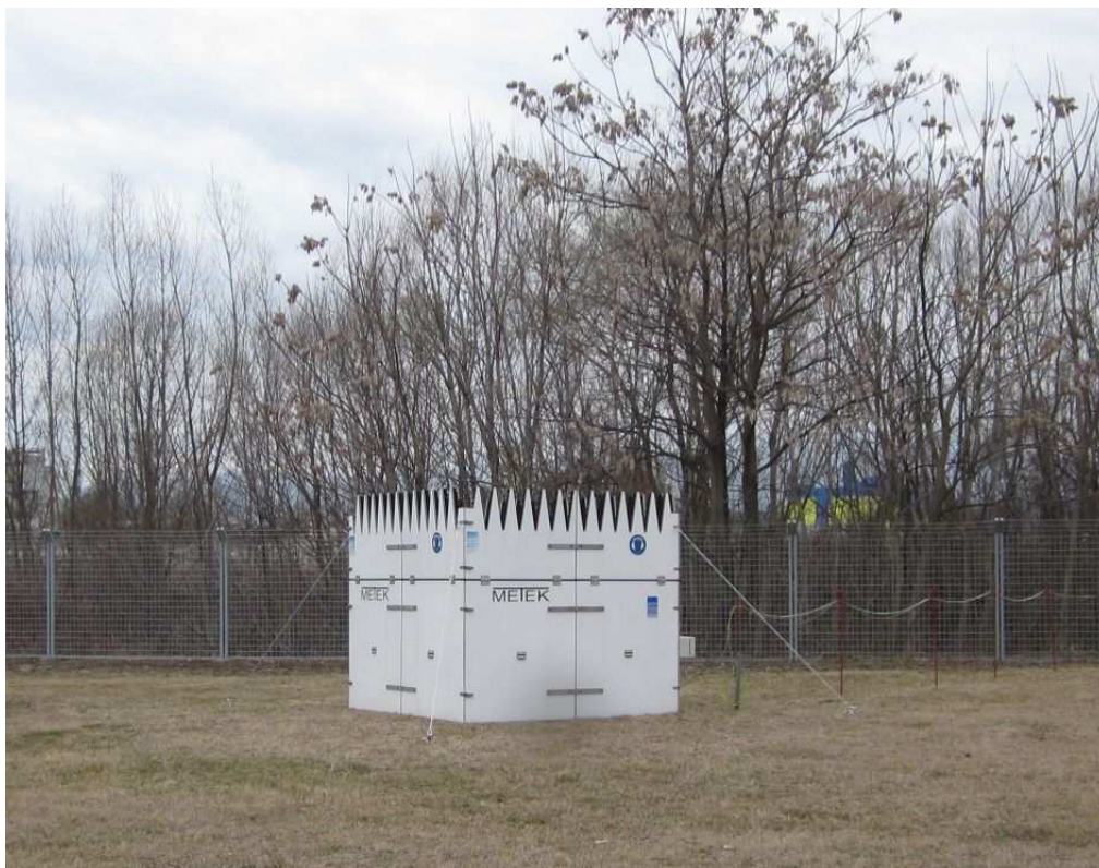
Slika 7 - V Sloveniji je MEIS d.o.o. v bližini marsikaterega večjega industrijskega objekta ocenjeval vpliv izpustov onesnaževal v zrak s pomočjo avtomatskih meritev navpičnih profilov vetrov s SODAR-jem
