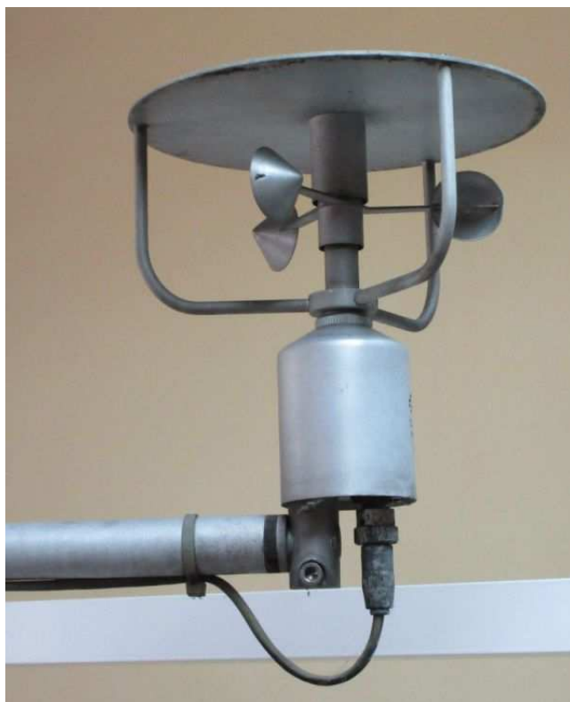
Slika 2 - Posebni optoelektronski senzor z magnetnimi ležaji, izdelan na IJS konec 80. let preteklega stoletja za zanesljivejšo meritve šibkih vetrov
