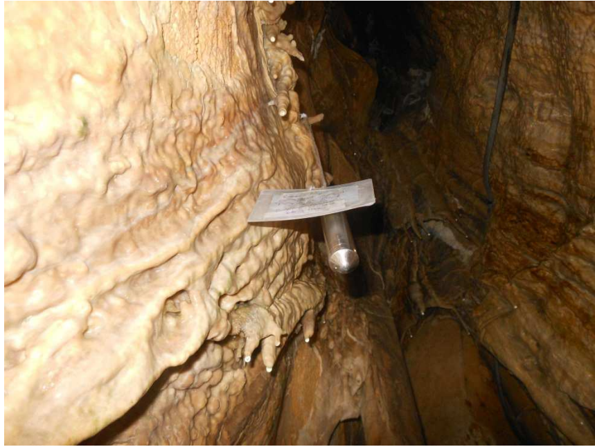
Slika 3 – Lehman Caves (Nevada) – položaj merjenja temperature zraka ( ^{\circ}\text{C} ) in zračnega tlaka (GBNP 1). Foto: S. Šebela
