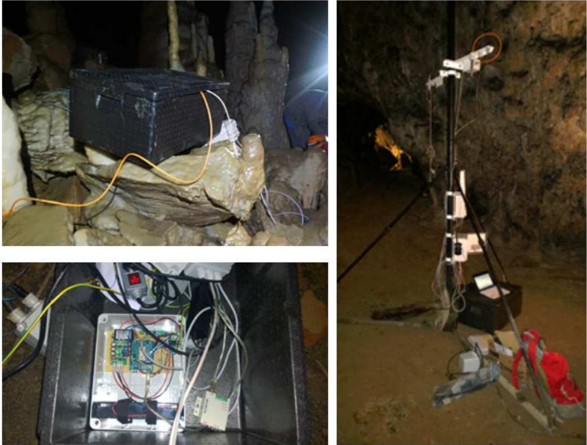
Slika 4: Slike jamskih avtomatskih merilnih postaj za meritve na lokacijah »Pisani rov« (levo zgoraj je slika izoliranega ohišja v katerem se nahaja merilni vmesnik, levo spodaj pa slika okoljskega vozlišča »JaMo« prav tako v izoliranem ohišju) in »Vodopad« (desno)
