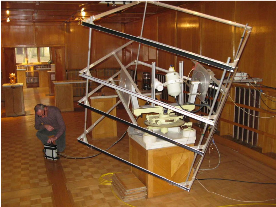
Slika 3: Primerjalna meritev Overhauserjevega protonskega magnetometra v sistemu tuljav z regulacijo gostote magnetnega polja
