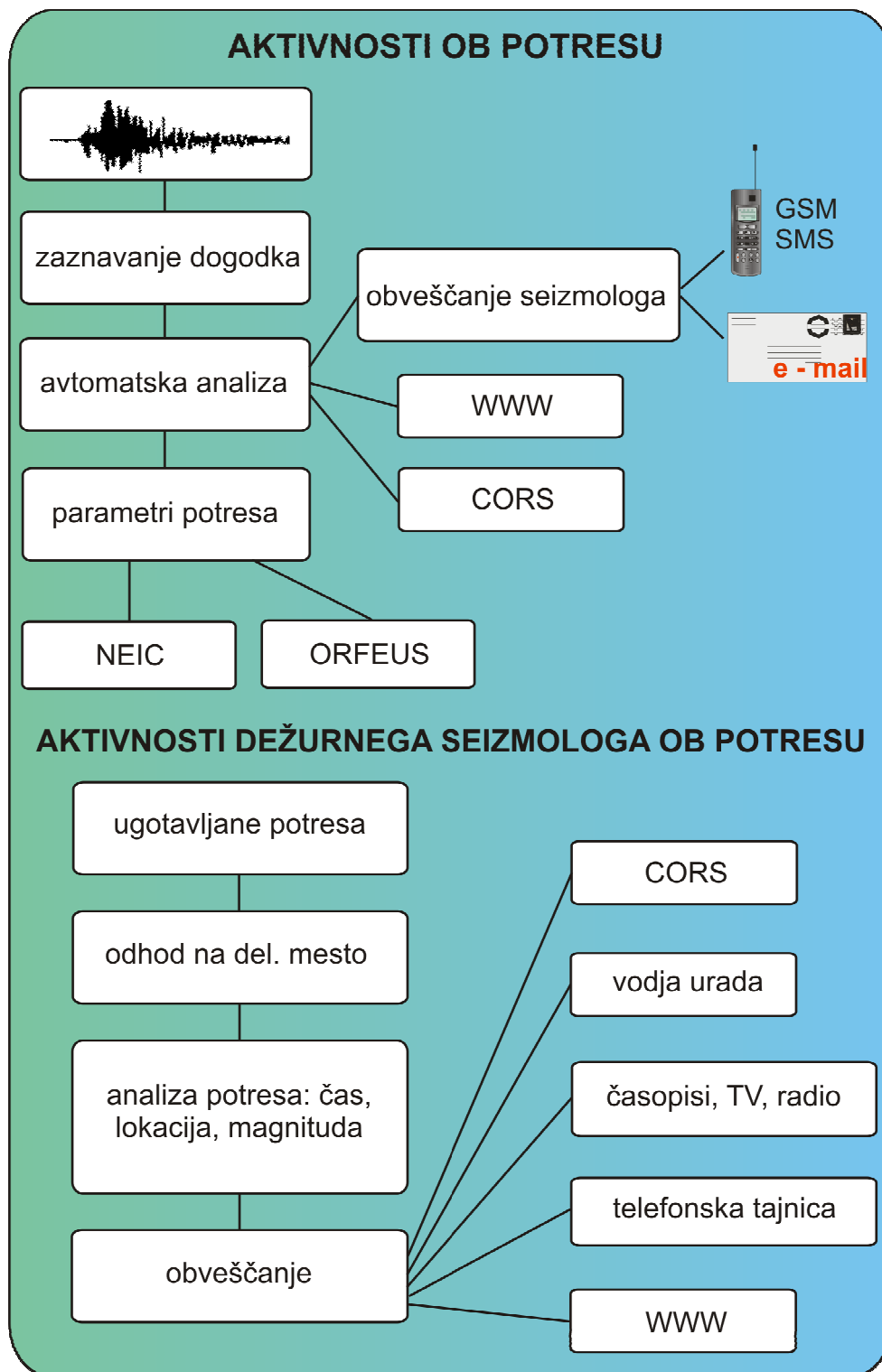
Slika 5: Shema avtomatskih aktivnosti in ukrepanje dežurnega seizmologa ob močnejšem potresu (Sinčič)
