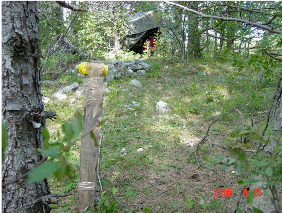
Slika 2: Postavljen in zaščiteno Overhauserjev protonski magnetometer GSM-19 (senzor)
