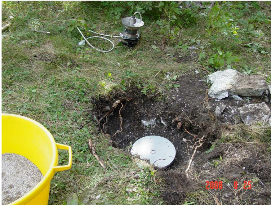
Slika 1: Položaj postavljanja trokomponentnega magnetometra MAGSON 11 (senzor)
