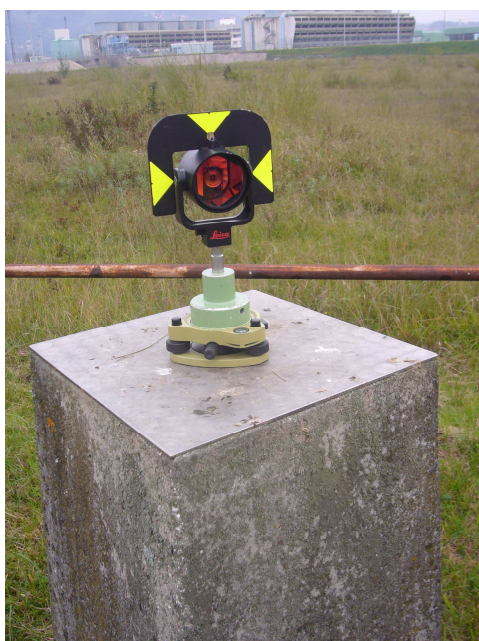
Slika 3 - Stabilizacija in signalizacija opazovalnega stebra in kontrolne točke
