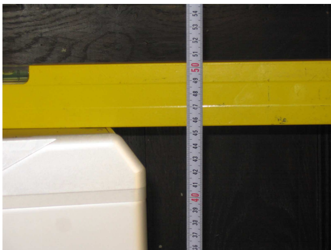
Slika 3 - Primer dokumentiranega merjenja višine instrumenta
