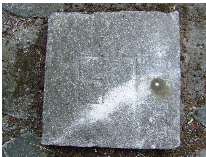
Slika 3 - Čep, s katerim so stabilizirane relativne gravimetrične točke
