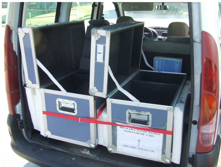
Slika 2 – Namestitev zabojev za prevoz relativnih gravimetrov v avtu
