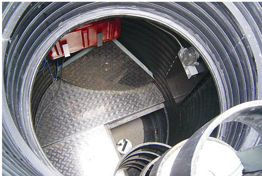
Slika 4 - V seizmičnem jašku sta nameščena senzor in zajemalna enota.
