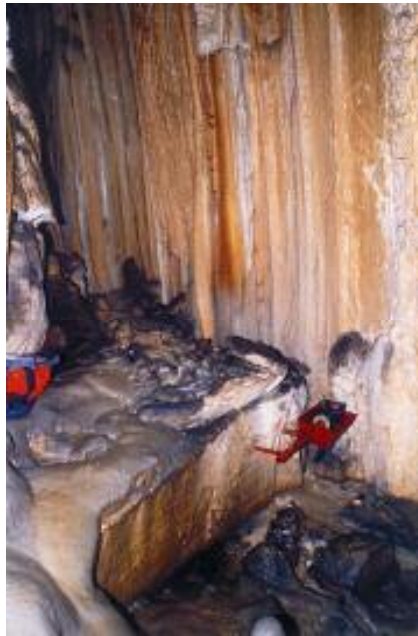
Slika 3 - Namestitev ekstenziometra TM 71 v Postojnski jami - Velika gora (Postojna 1)
