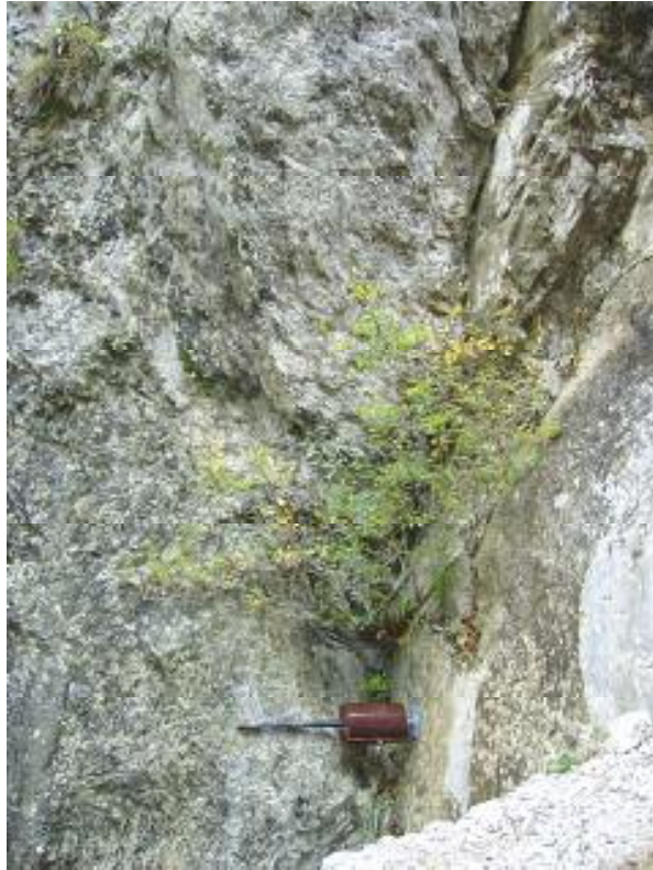
Slika 7 - Namestitev ekstenziometra TM 71 na glavni prelomni ploskvi Idrijskega preloma v dolini Učje
