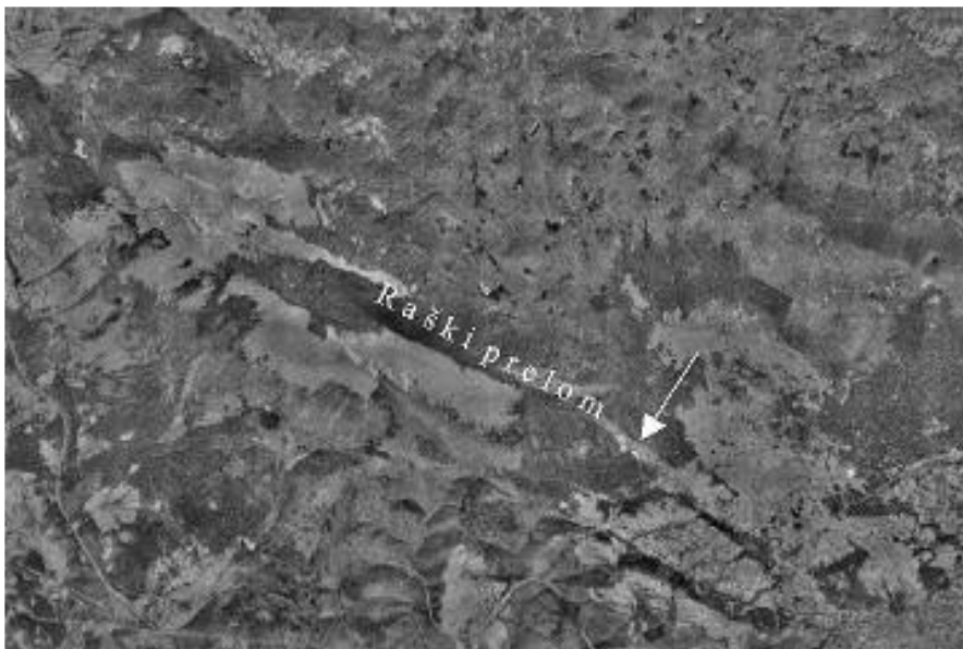
Slika 5 - Letalski posnetek (DOF5 GURS) Vremščice z Raškim prelomom. Označen je kamnolom v katerem je nameščen ekstenziometer TM 71
