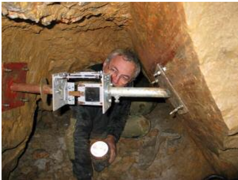
Slika 4 - Namestitev ekstenziometra TM 71 v Postojnski jami - Lepe jame (Postojna 2)
