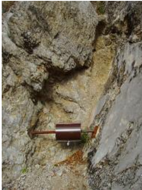
Slika 6 - Namestitev ekstenziometra TM 71 na Raškem prelomu, Vremščica
