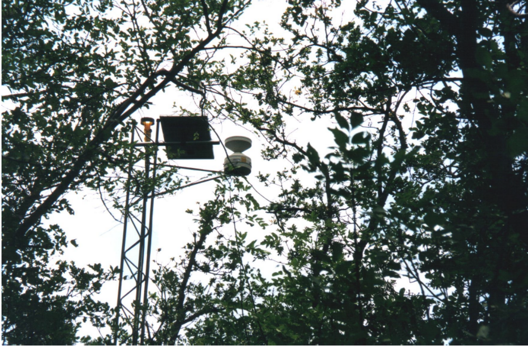
Slika 3: Ombrograf in totalizator za merjenje padavin nad drevesnimi krošnjami na južni raziskovalni ploskvi
