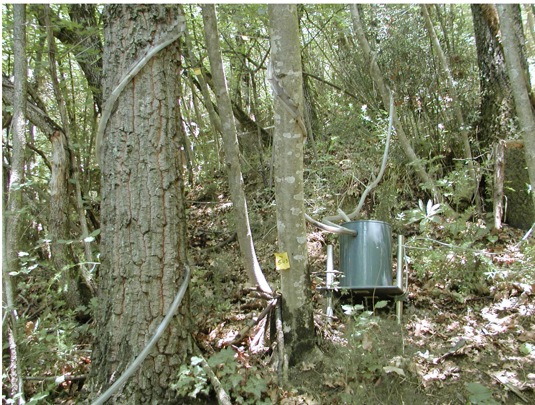
Slika 5: Merjenje odtoka po deblu na južni raziskovalni ploskvi
