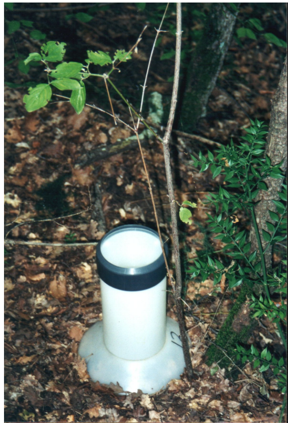
Slika 4: Korito (a) in totalizator (b) za merjenje količine padavin, ki padejo skozi krošnje
