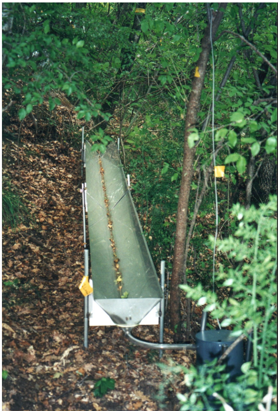
Slika 4: Korito (a) in totalizator (b) za merjenje količine padavin, ki padejo skozi krošnje
