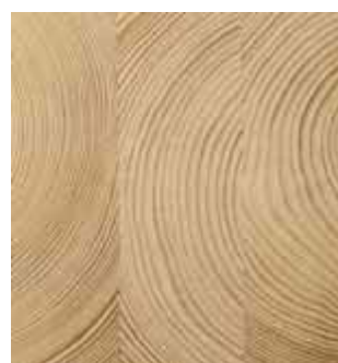
Prečna prereza lepljenih elementov iz dveh in treh delov (DUO in TRIO NOSILCI)
