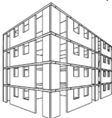
Slika 6 Masivna nosilna konstrukcija.
