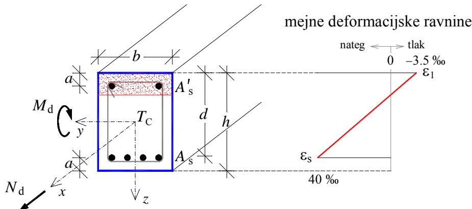
Tabela za projektiranje natezne armature pri pravokotnem prečnem prerezu, obremenjenem z upogibom in osno silo:
