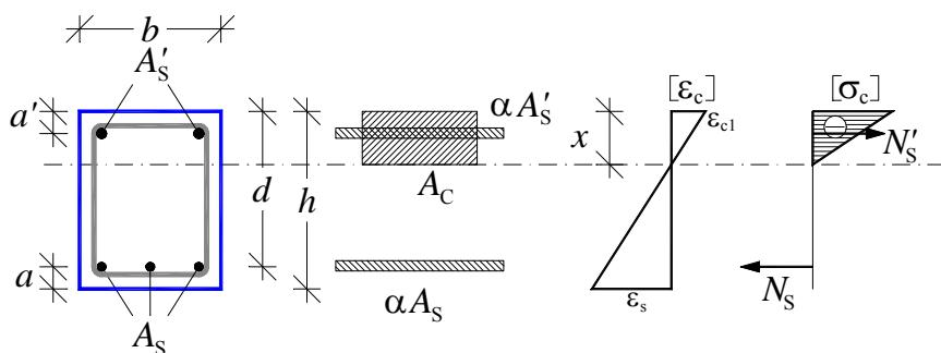
(i) globina nevtralne osi prereza  $x$  - izračunamo jo z enačbo, ki velja za pravokotni prečni prerez in je izpeljana na osnovi ravnotežja statičnih momentov betona in armature okrog nevtralne osi:
