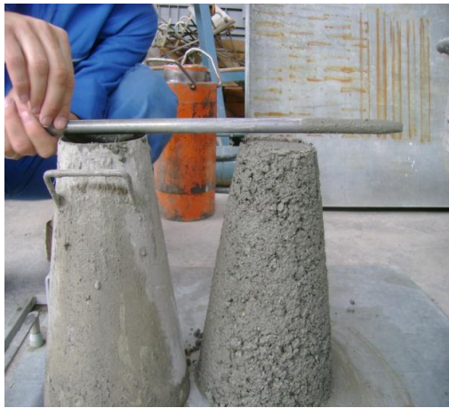
Slika 7 Posed stožca svežega betona.
