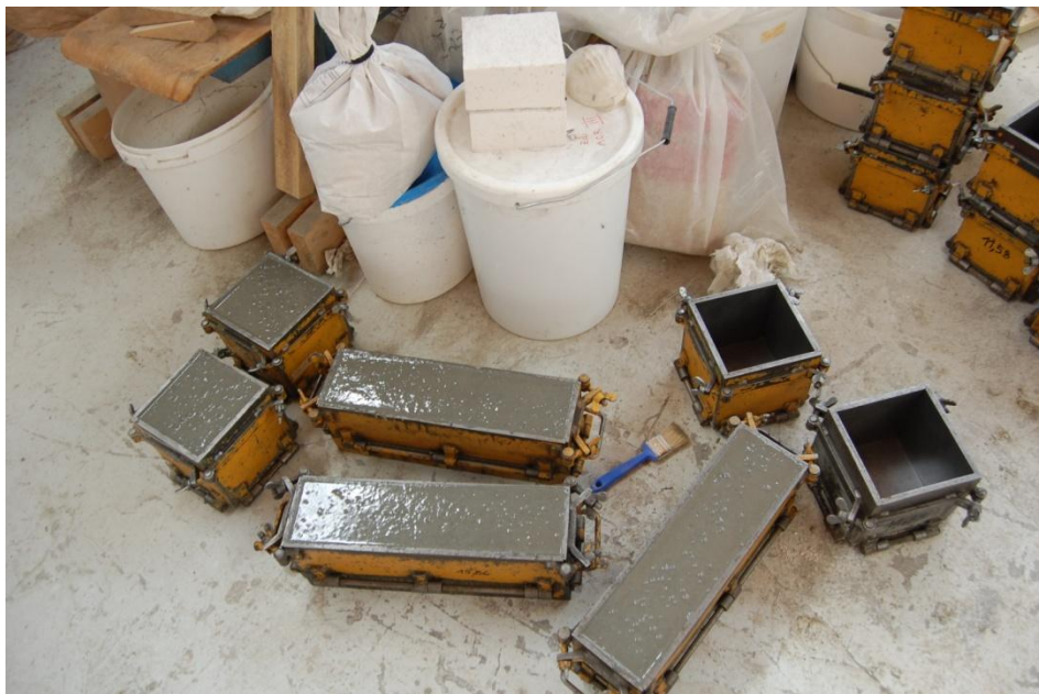
Slika 11 Kalupi za vgradnjo betonskih kock in prizem za preiskušanje tlačne in upogibne trdnosti.
