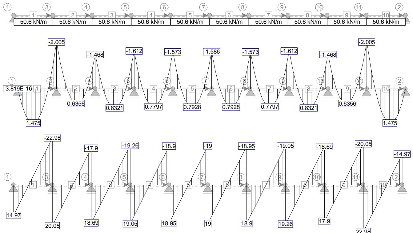
Pomiki opaža [v cm] za linijsko obtežbo  $q_{d,MSU} = 50.6 \text{ kN/m}$  ( $e_h = \text{m}$ ):
