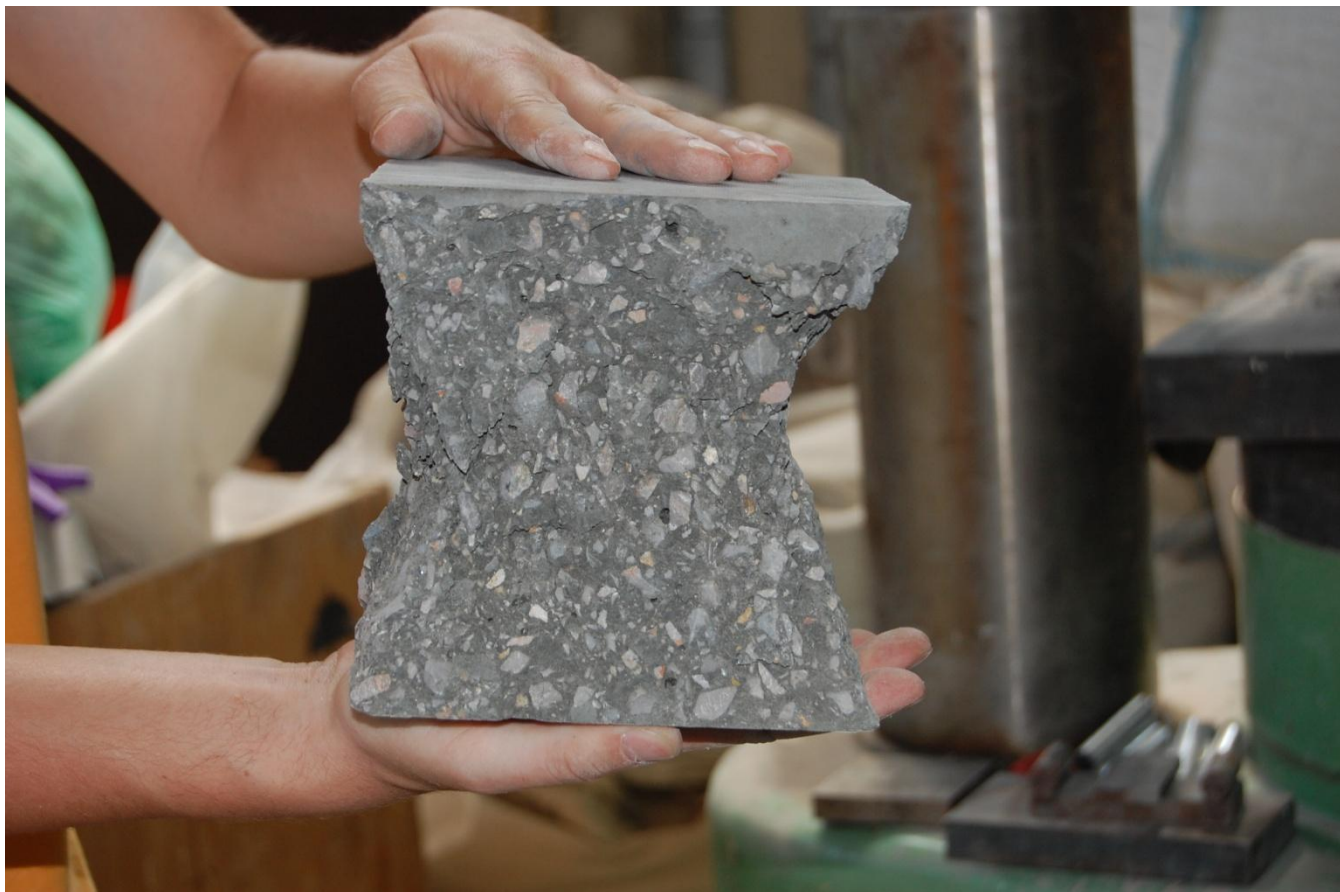
Slika 3 Običajna oblika porušitve betonskega vzorca obteženega z enosno tlačno silo.
